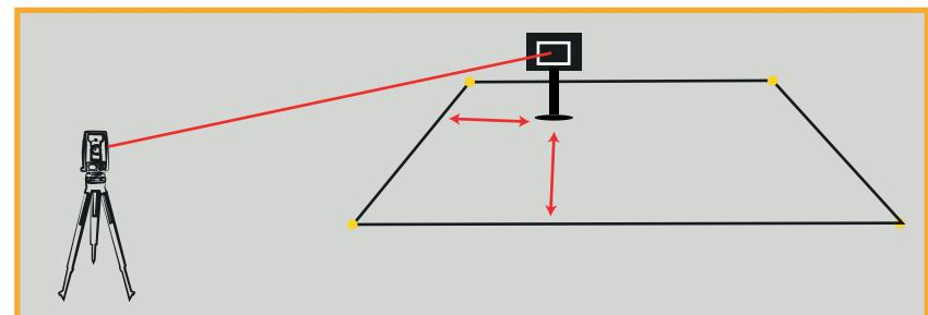
La construcción de tablones es la base de la construcción. Es posible elegir los ejes relativos a replantear en función de la posición de los puntos durante la fase de diseño. Con esta función simple e intuitiva de Replanteo con ejes, ARC-Zero lo ayudará a encontrar el punto a replantear de manera fácil y precisa.
